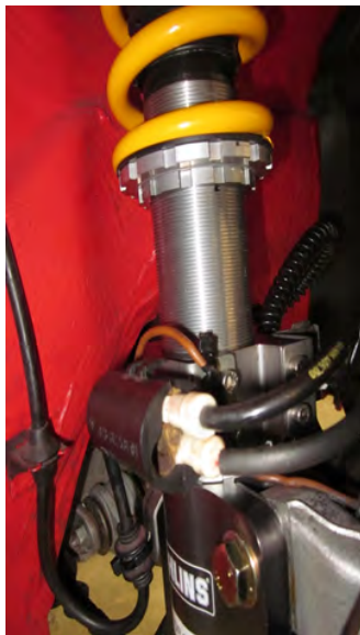
Abb.2 Dämpfer am Radträger montiert
