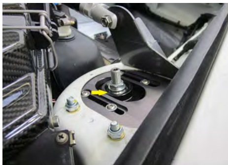
Abb.4 Sturzverstellung Domlager
