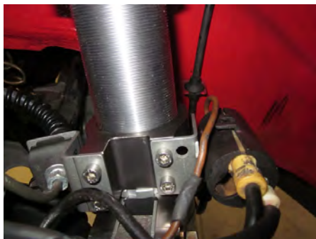
Abb.1 Bremsleitung und Kabel sind auf dem neuen Halter am Öhlins Federbein angebracht.
