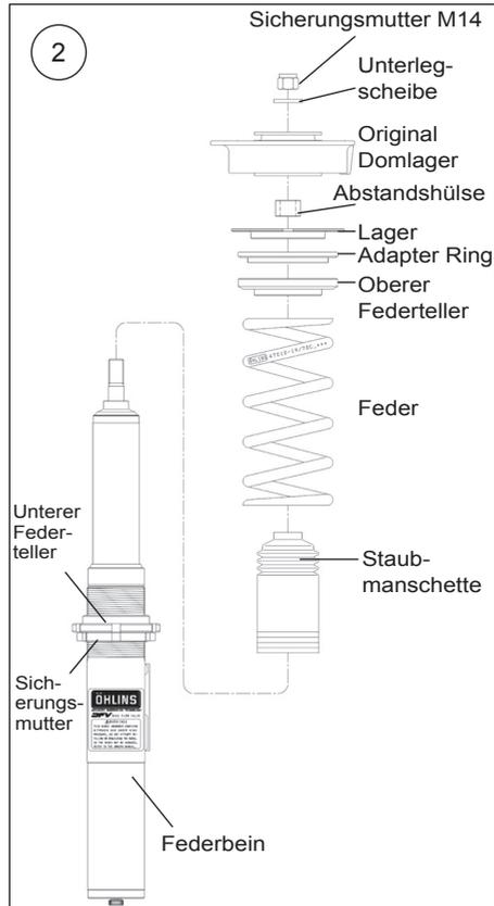
oberen Federteller und die Abstandshülse über das Federbein gemäß Abbildung 2. Montieren Sie das originale Domlager, die Unterlegscheibe und die Sicherungsmutter M14.
