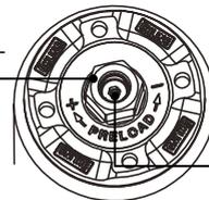
Druck- / Zugstufeneinsteller
