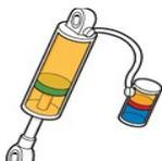
H: Gasdruck-Dämpfer mit externem Reservoir und Hochdruck-Schlauchverbindung.
