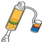
H: Gasdruck-Dämpfer mit externem Reservoir und Hochdruck-Schlauchverbindung.
