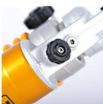
C1: Einstellbare Druckstufendämpfung. Verstellrad oder Inbus am Reservoir.
