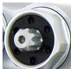
R1: Einstellbare Zugstufendämpfung. Schwarzer Einsteller am TTX36 Federbein / silberner Einsteller am TTX GP Federbein.
