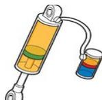
H: Gasdruck-Dämpfer mit externem Reservoir und Hochdruck-Schlauchverbindung.
