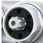
R1: Einstellbare Zugstufendämpfung. Schwarzer Einsteller am TTX36 Federbein / silberner Einsteller am TTX GP Federbein.
