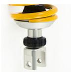
R1: Einstellbare Zugstufendämpfung am Einrohrdämpfer. Verstellrad über dem Endauge.
