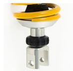
R1: Einstellbare Zugstufendämpfung am Einrohrdämpfer. Verstellrad über dem Endauge.
