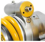
B: Integrierter hydraulischer Federvorspannungsversteller.
