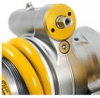
B: Integrierter hydraulischer Federvorspannungsversteller.
